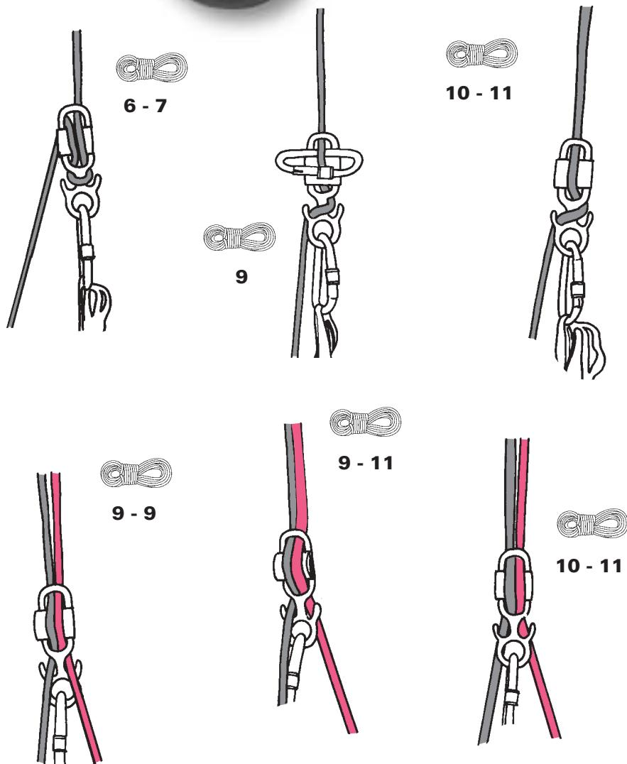
**Inserimento** della corda doppia nel discensore **Introduction** de la corde double dans l'auto-bloqueur Robot
